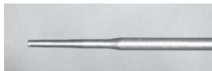
図2 iNP-40の先端部の拡大写真
