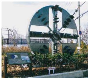
写真2 シールドカッターヘッド、下水道合流貯留管とその整備計画地図
