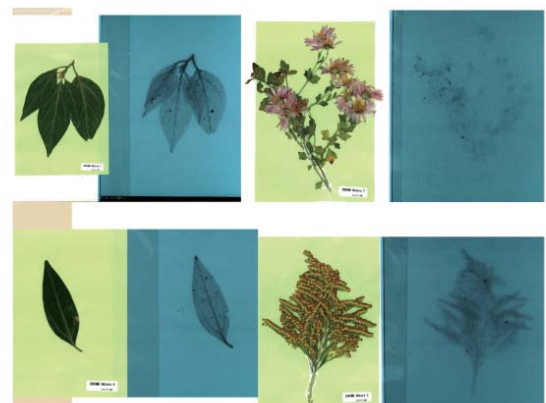
集会所の雨どいでは 250 マイクロシーベルトを記録した (上) 現地の植物の放射線をイメージングプレートで記録 (下)
